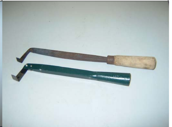
Hình 4: Dao cạo thông thường (phía trên) so với dao cạo ngựa lắp ghép
