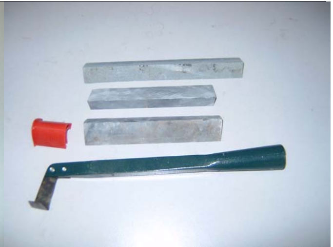
Hình 2: Dao cạo ngựa lắp ghép hoàn chỉnh và đá nhám, đá bùn để mài dao
