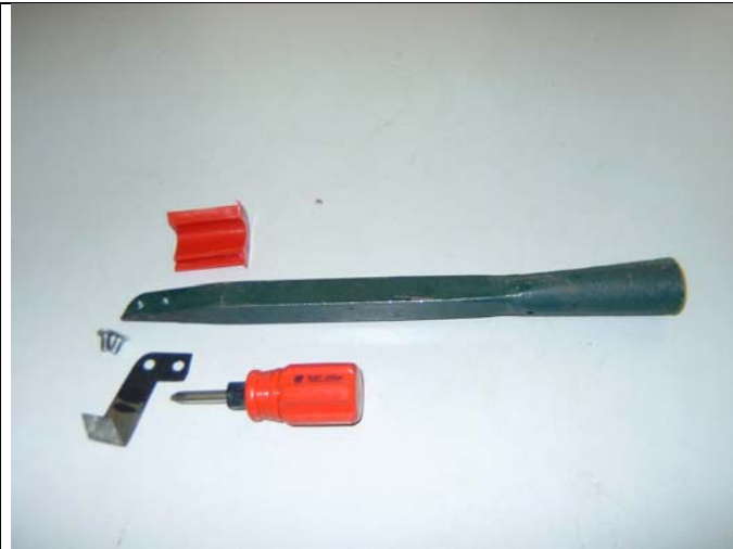
Hình 1: Lưỡi dao, thân dao cạo ngựa lắp ghép và các dụng cụ để gắn lưỡi dao như ốc, tuộc nơ vít
