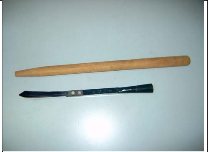
Hình 6: Dao cạo úp lắp ghép hoàn chỉnh và cán dao có thể gắn dễ dàng và thay đổi độ dài khi cạo úp ở các độ cao khác nhau
