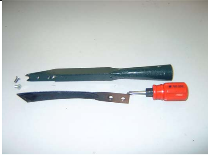
Hình 5: Lưỡi dao, thân dao cạo úp lắp ghép và các dụng cụ để gắn lưỡi dao như ốc, tuốc nơ vít
