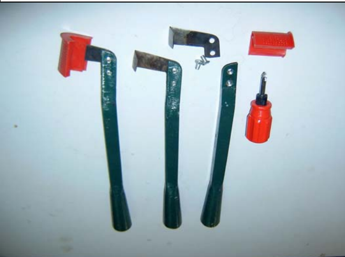
Hình 1: Lưỡi dao, thân dao cạo ngựa lắp ghép và các dụng cụ để gắn lưỡi dao như ốc, tuộc nơ vít
